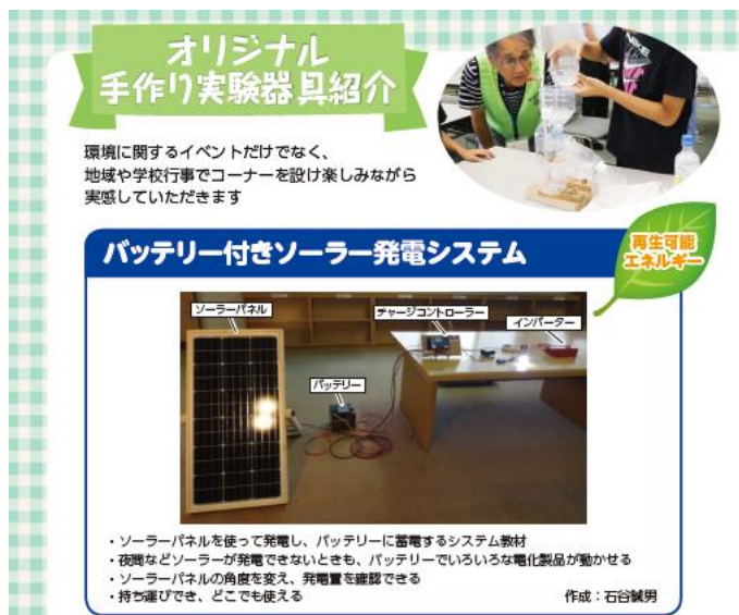
<バッテリー付きソーラー発電システム>
