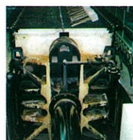
②脱水機(濃縮された汚泥をさらに圧縮し、水分をとりぬく)
