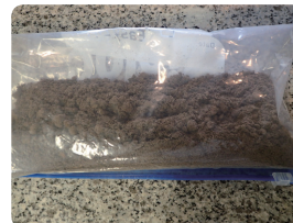
高島浄化センターの下水汚泥から作った試験コンポスト
