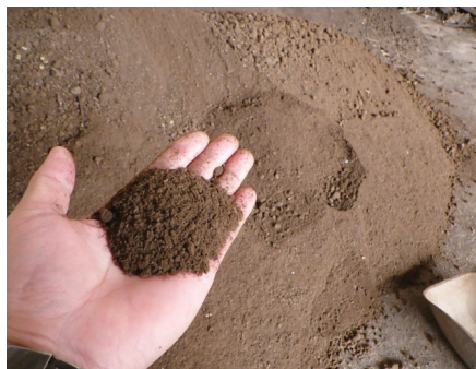
高島の下水汚泥から試験的に製造した肥料
